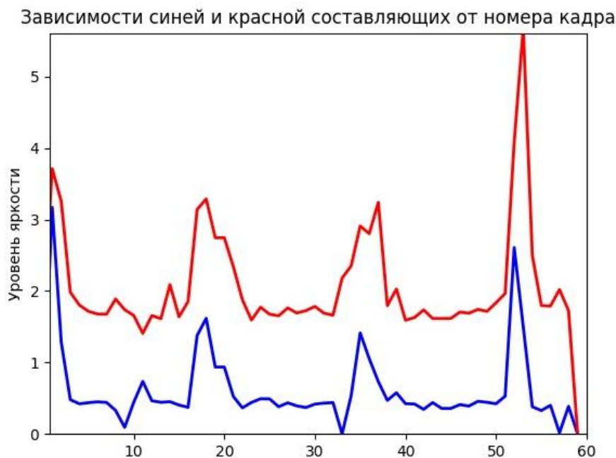
Рис 2 Результаты обработки кадров при работе ДВС на пропан бутане при стехеометрическом составе смеси
