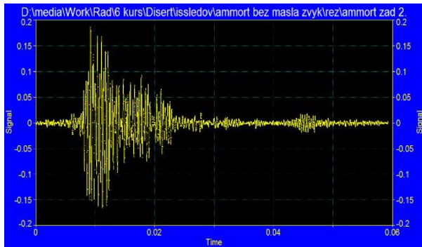
Рис. 3. Амортизатор с заводским уровнем масла
