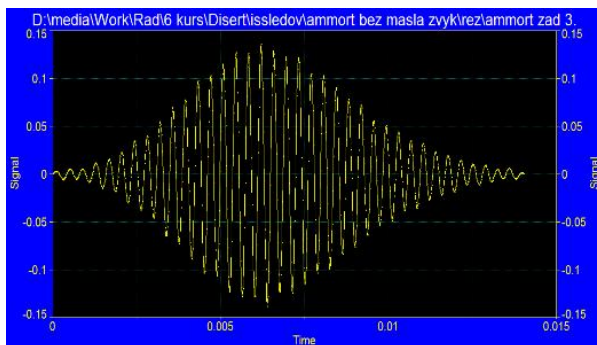
Рис. 5. Сигнал работы амортизатора с частично слитым маслом
