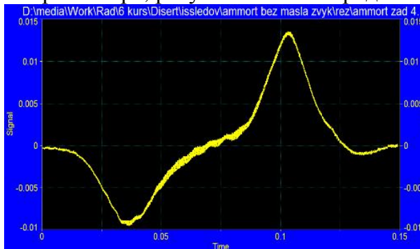
Рис. 7. Сигнал, работа амортизатора без масла
