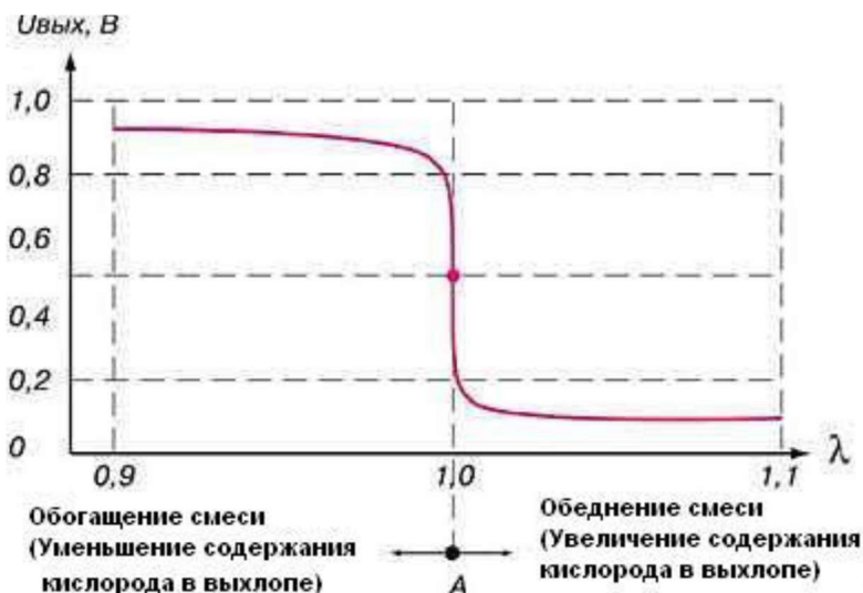
Рисунок 2 – график зависимости напряжения лямбда-зонда
