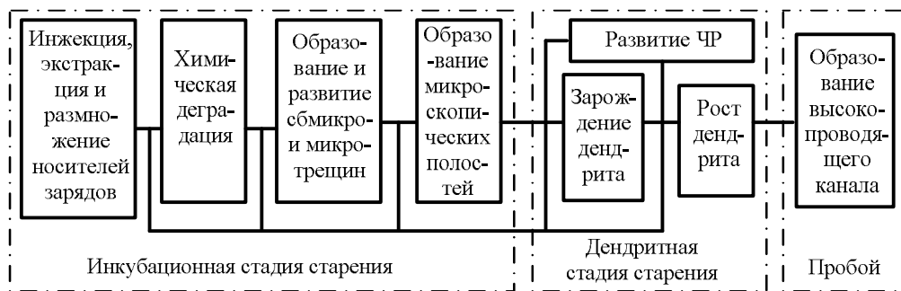
Рис.1 Алгоритм электрического старения и пробоя изоляции
