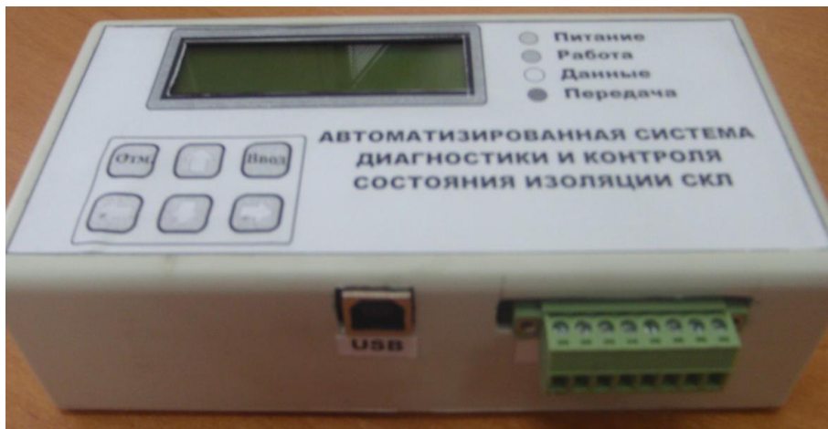
Рис.3 Внешний вид устройства прогнозирования неисправностей СКЛ
