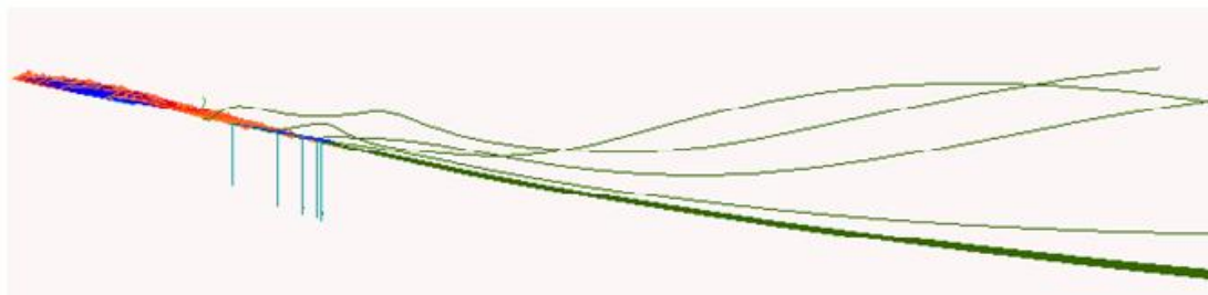
Рис. 3 Скос потока крыла при скорости в 4 м/с и угле в 10^\circ
