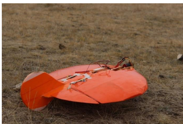
Рис. 5 Один из опытных образцов БПЛА с эллиптическим крылом
