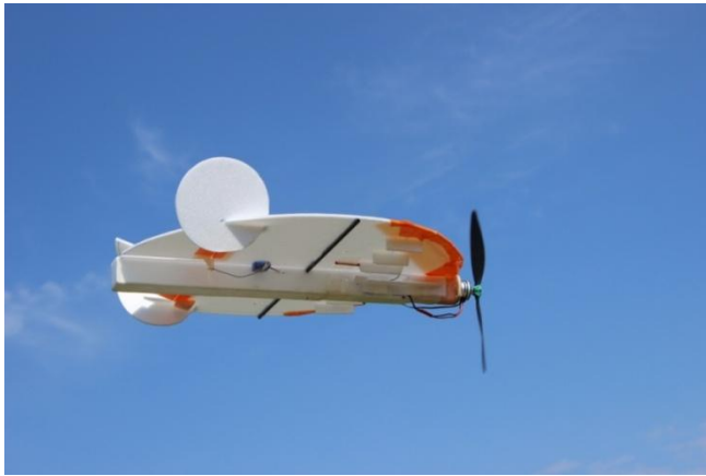
Рис. 8 Облегченная модель БПЛА с эллиптическим крылом
