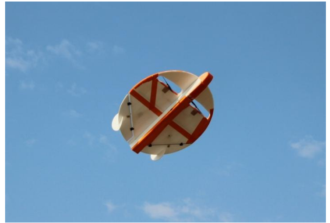
Рис. 9 2-х моторный БПЛА с эллиптическим крылом
