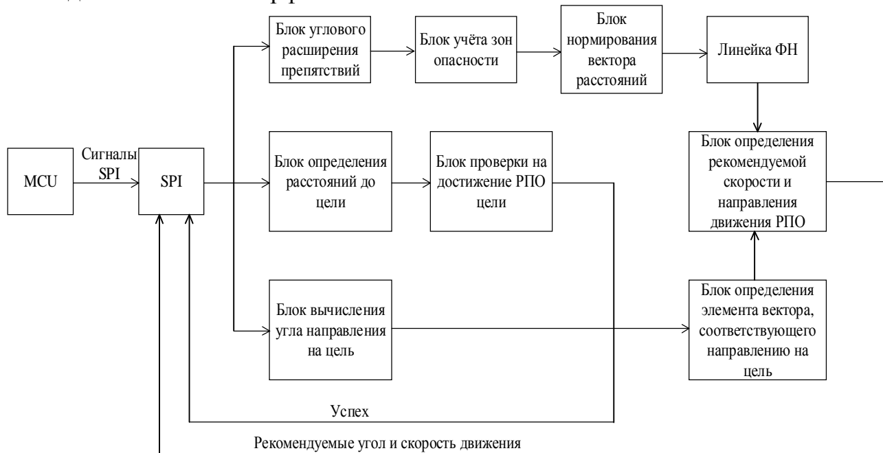
Рис.5. Структурная схема аппаратной реализации алгоритма
