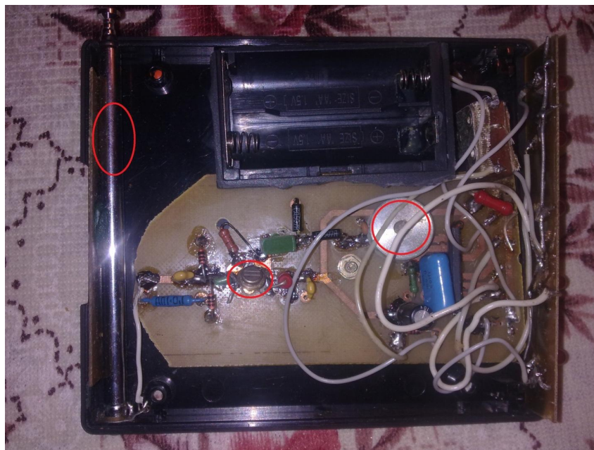
Рисунок 3 – Печатная плата детектора СВЧ излучения
